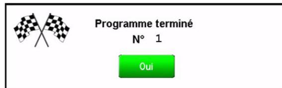
Tant que l'utilisateur ne clique pas sur **Oui**, la machine continuera à réguler la température et le débit d'air selon les consignes de la dernière ligne du programme pour ne pas causer un choc thermique sur les DUT.
