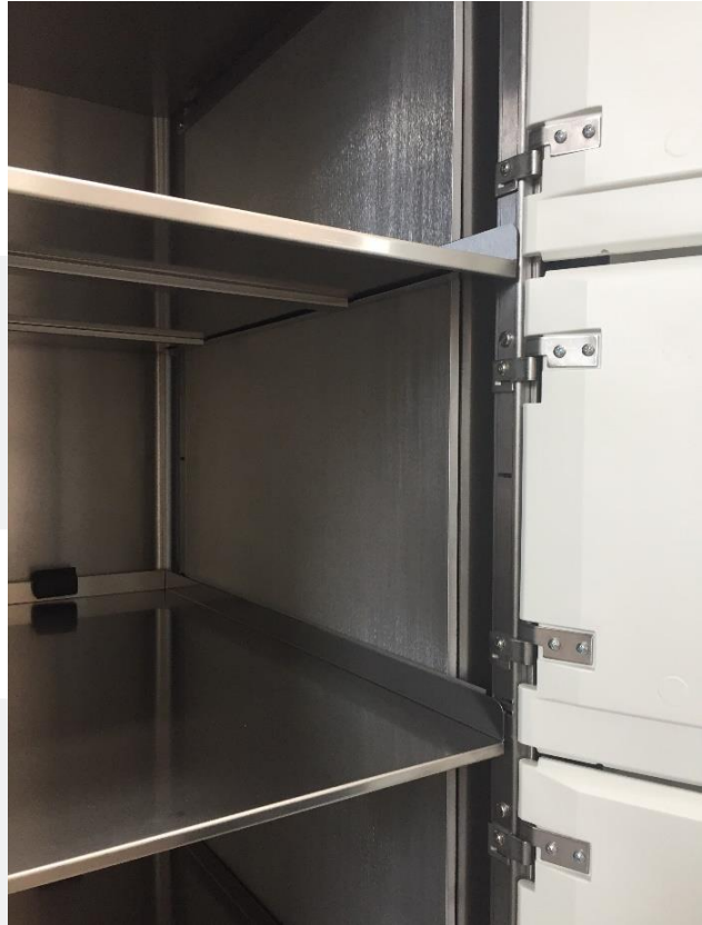
Photo 2 : Plaque cryo-accumulatrice placée sur le côté droit d'un congélateur, vue centrale intérieur droite
