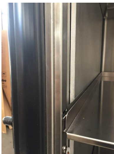
Photo 3 : Plaque cryo-accumulatrice placée sur le côté droit d'un congélateur, vue de trois-quart intérieur
